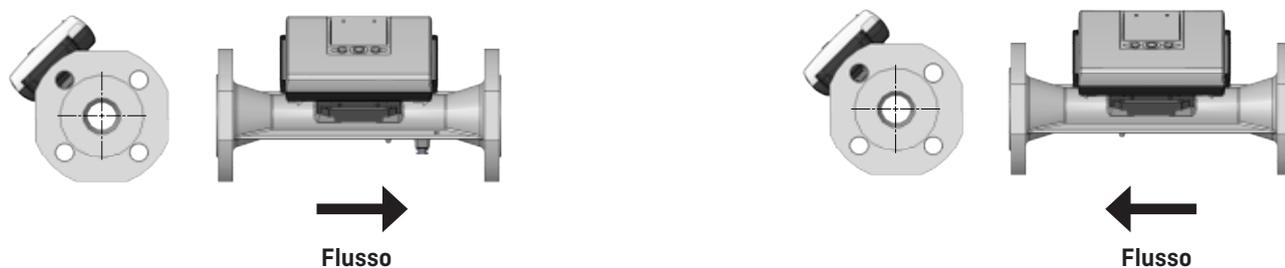
**Nota:** A temperature del fluido superiori a 90 °C, non montare il calcolatore e il Pulse Transmitter sul sensore di portata. Si consiglia invece il montaggio a parete.
