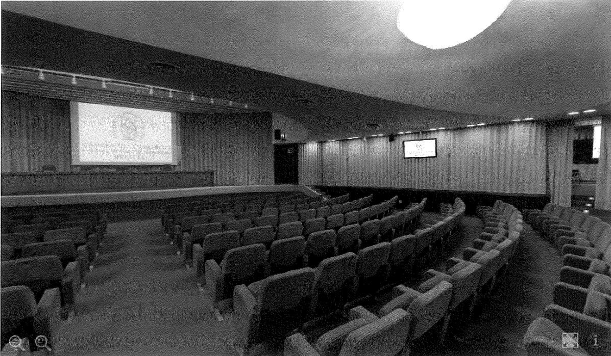
Il rivestimento in legno dello schienale ha la funzione di protezione della poltrona, nello schienale è ricavata una tasca porta documenti. Le poltrone sono disposte a semicerchio, diviso in quattro settori da corsie. La pavimentazione è in parte orizzontale e in parte inclinata con differente gradazione per consentire una visibilità ottimale del palco da ogni posto in platea.
